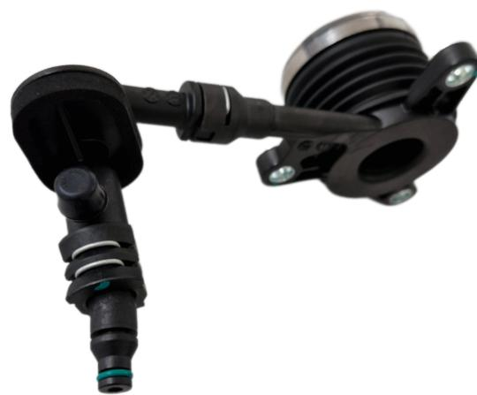
Purgador paralelo de la conexión de la línea; la apertura del purgador se realiza girando la perilla en contra de las manecillas del reloj.
